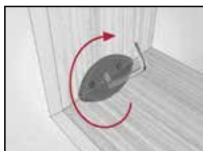
Assemblage du corps du meuble par système invisible «Clamex»
